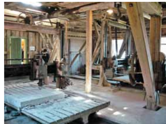
Fig 7.1 Stenhyvel, tillverkad 1889. Ursprungligen ångdriven. Råbäcks Mekaniska Stenhuggeri.
