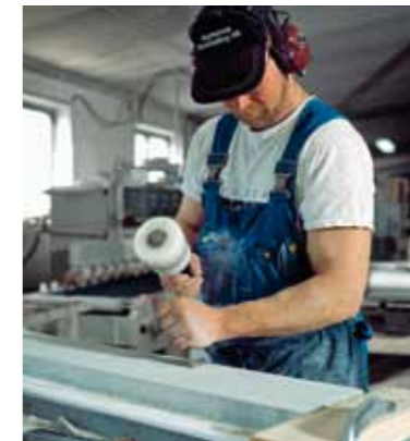
Fig 7.3 Lågerhuggning av kalksten med klubba och mejsel
