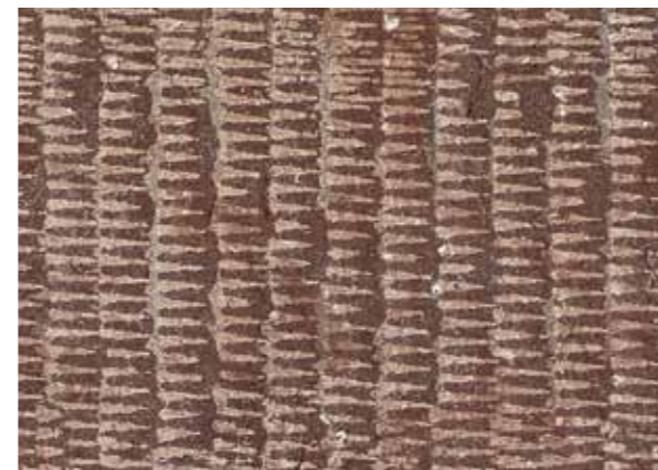
Fig 7.11 Tandhuggen, röd kalksten. Nyhuggen, skala 1:1
